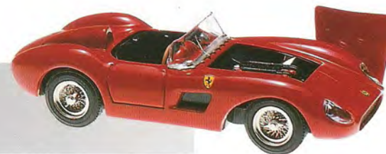
Ferrari 500 TRC 1956 - Carrozzeria: Scaglietti Motore: 4 cilindri in linea di cc 1984,85 CV 190 a 7400 giri/min. velocità 240 km/h-Versione "Prova"
