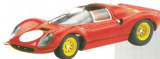
Ferrari Dino 206/s 1966 Carrozzeria: Sport Cars di P. Drogo Motore: 6 cilindri di cc 1986 CV 218 A 9000 giri/min. velocità 286 km/ora - Versione "Prova".
