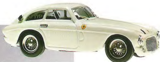
Ferrari 166 MM Coupé - Carrozzeria: Touring Motore: 12 cilindri a V di 60° cilindrata cc 1995 CV 160 a 7200 giri velocità 200 km/h - Versione: "Prova"
