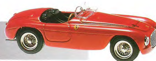
Ferrari 166 MM Spyder - Carrozzeria: Touring Motore: 12 cilindri a V di 60° cilindrata cc 1995 CV 160 a 7200 giri velocità 200 km/h - Versione: "Prova"
