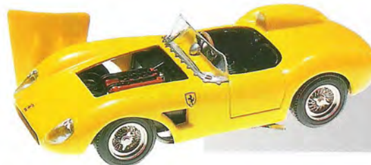
Ferrari 500 TRC 1956 - Carrozzeria: Scaglietti Motore: 4 cilindri in linea di cc 1984,85 CV 190 a 7400 giri/min. velocità 240 km/h-Versione "Prova"
