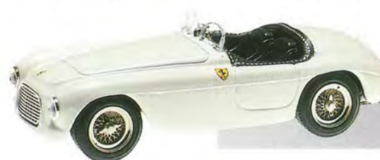
Ferrari 166 MM Spyder - Carrozzeria: Touring Motore: 12 cilindri a V di 60° cilindrata cc 1995 CV 160 a 7200 giri velocità 200 km/h - Versione: "Prova"
