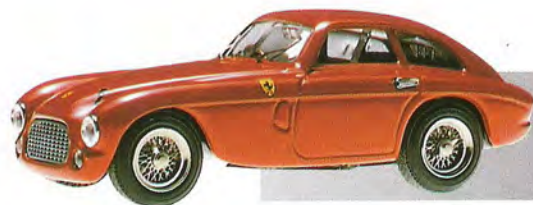
Ferrari 166 MM Coupé - Carrozzeria: Touring Motore: 12 cilindri a V di 60° cilindrata cc 1995 CV 160 a 7200 giri velocità 200 km/h - Versione: "Prova"
